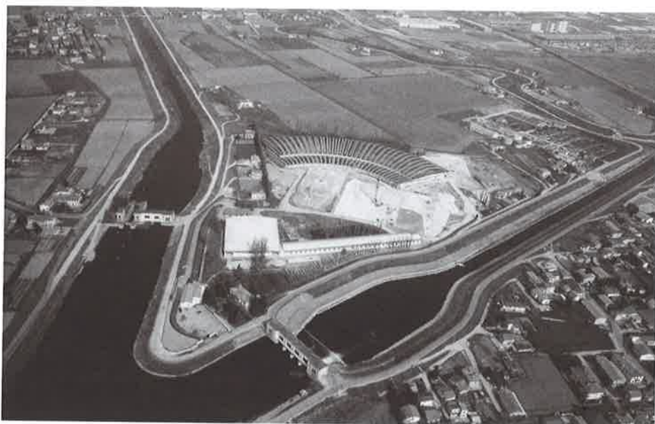
Il centro sperimentale per modelli idraulici di Voltabarozzo. L'edificio ad arco contiene il modello della laguna di Venezia in scala planimetrica 1:250
