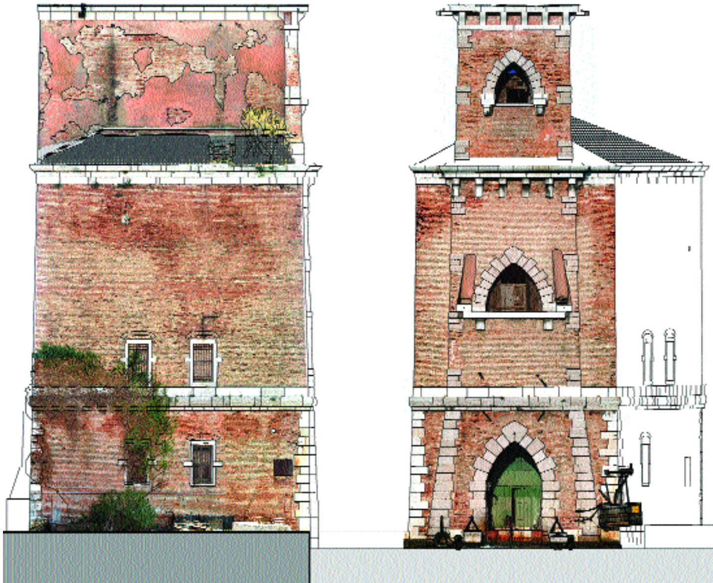
Vista d'insieme del rilievo fotogrammetrico dei prospetti della torre di Porta nuova
