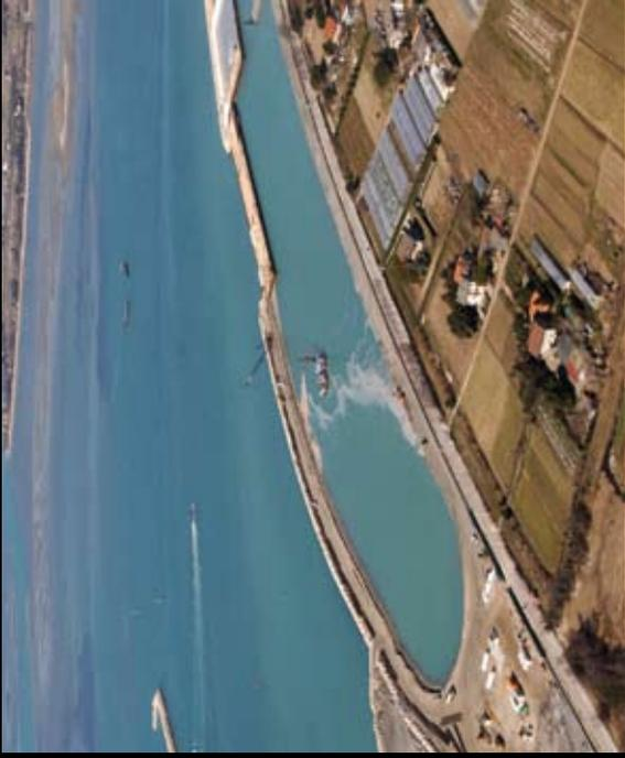
Nel **bacino** lato mare, svuotato dall'acqua, è stato allestito il **cantiere** per costruire gli "alloggiamenti" per le paratoie di Lido nord
