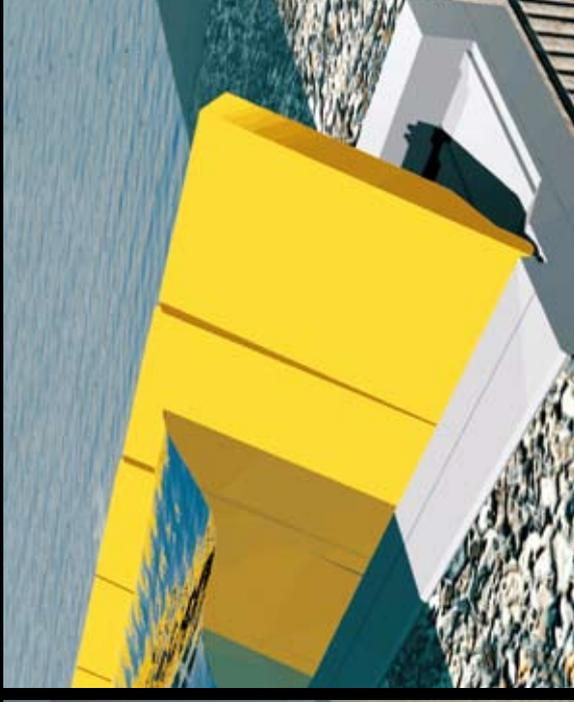
Le **paratoie** sono installate negli "alloggiamenti". La **barriera** è completata e funzionante
