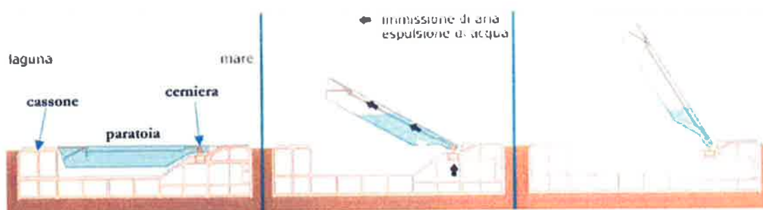
Fig. 4 – Funzionamento della paratoia.
