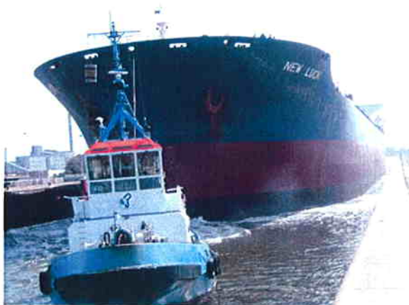
FIG. 12.3 - APPROCCIO DI UNA NAVE ALLA CONCA CON DUE RIMORCHIATORI (UNO A POPPA E UNO A PRUA) E INGRESSO IN CONCA
