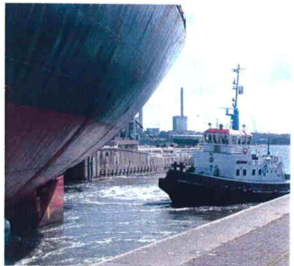
FIG. 12.3 - APPROCCIO DI UNA NAVE ALLA CONCA CON DUE RIMORCHIATORI (UNO A POPPA E UNO A PRUA) E INGRESSO IN CONCA
