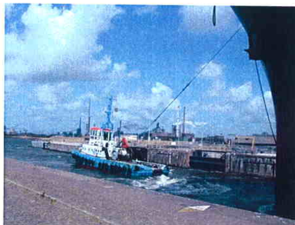
FIG. 12.4 - ORMEGGIO DURANTE IL LIVELLAMENTO (PER VIA DELLA PRESENZA DI UN FORTE VENTO TRASVERSALE), E SUCCESSIVA MANOVRA DI USCITA DALLA CAMERA DELLA CONCA
