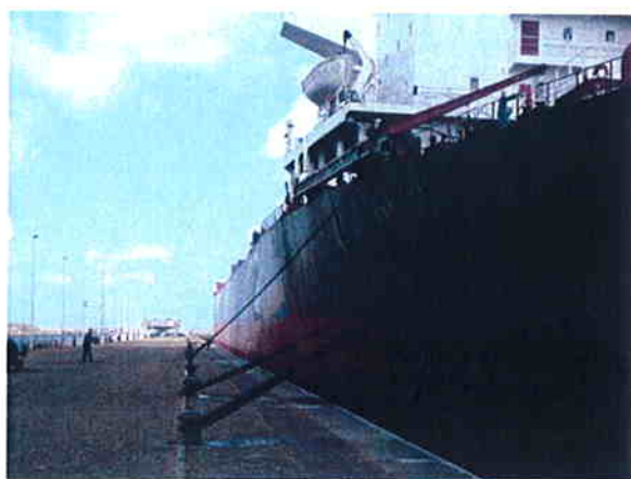
FIG. 12.4 - ORMEGGIO DURANTE IL LIVELLAMENTO (PER VIA DELLA PRESENZA DI UN FORTE VENTO TRASVERSALE), E SUCCESSIVA MANOVRA DI USCITA DALLA CAMERA DELLA CONCA
