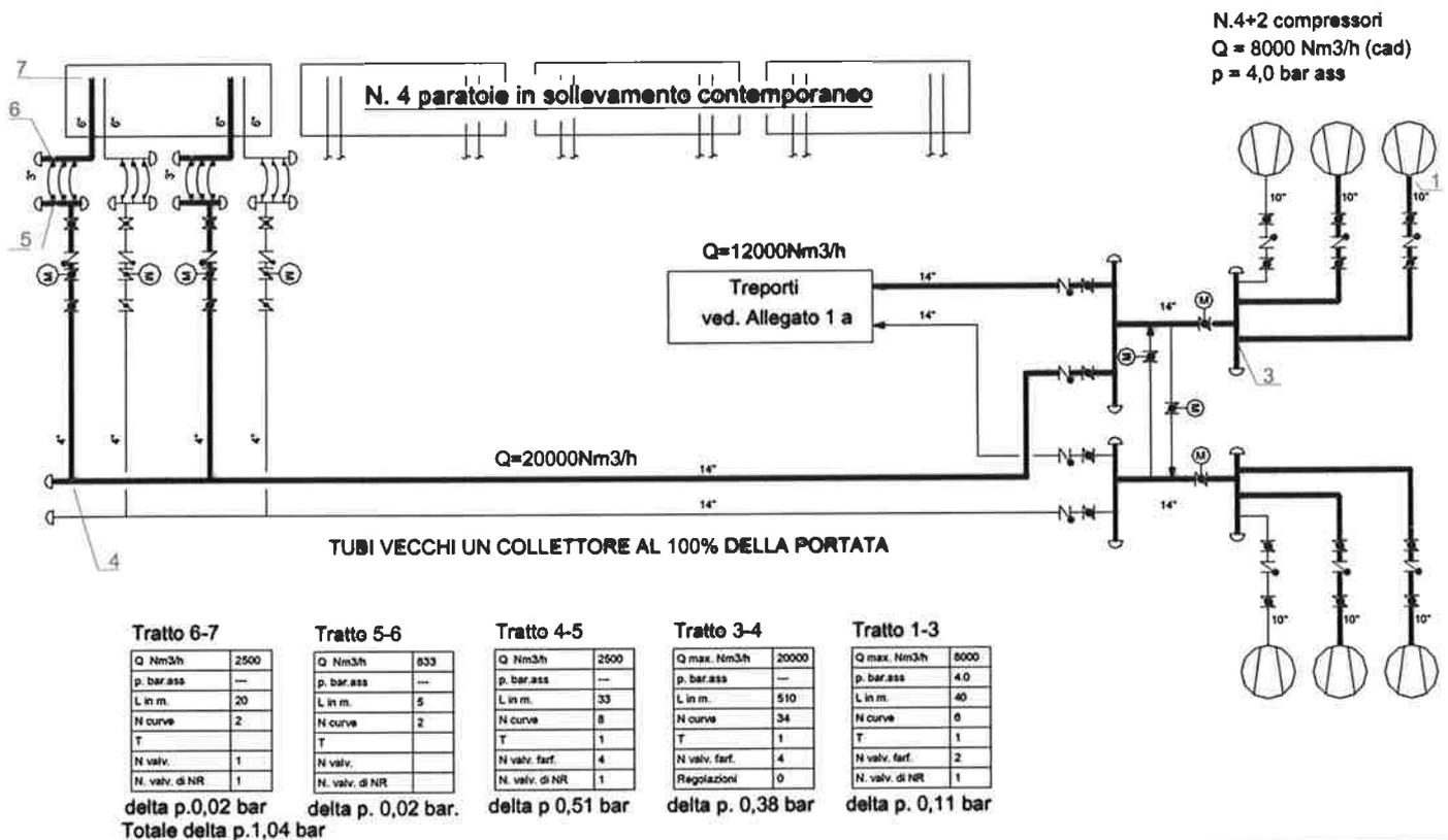
FIG. 4.2 –BARRIERA DI SAN NICOLÒ – SCHEMA EQUIVALENTE TUBAZIONI
