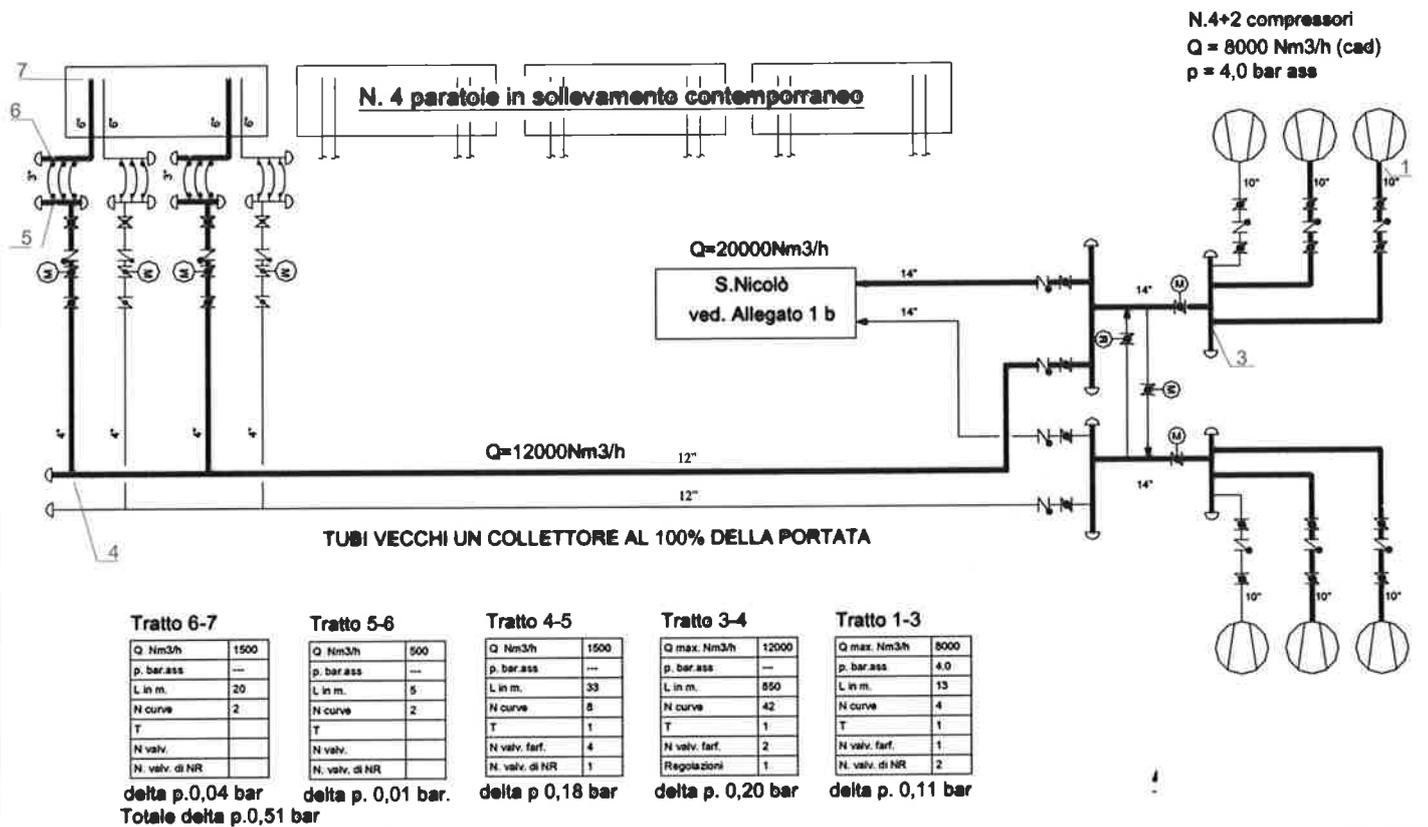
FIG. 4.1 –BARRIERA DI TREPORTI – SCHEMA EQUIVALENTE TUBAZIONI
