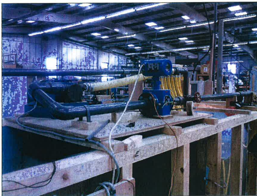
FIG. 7.3 - MODELLO FISICO – ASSIEME MODELLO CON POMPA DI INIEZIONE
