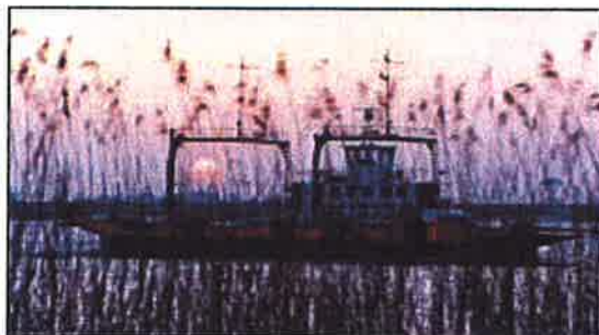
Double-ended ferry, 4 x SRP 170 (250 kW each) Shipyards: Lürssen-Werft/Kröger Werft, Germany Owner: Verkehrsbetriebe Wesermarsch GmbH, Germany
