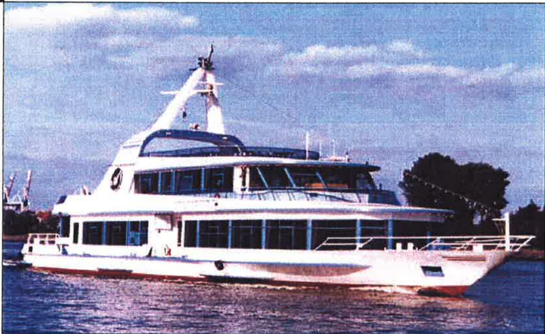
Passenger vessel, 2 x SRP 170 (284 kW each) Shipyard: Deutsche Binnenwerften GmbH, Germany Owner: Rainer Abicht Elbwerft GmbH, Germany
