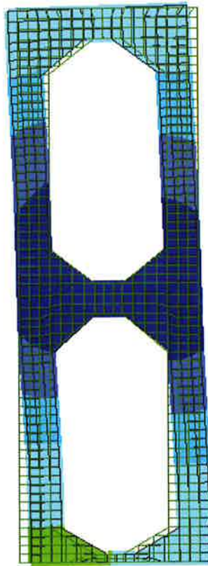
FIG. 12.22 – OSSATURE RINFORZATE – OSSATURA 02 – DISLIVELLO 2 M + CRESTA - DEFORMATA
