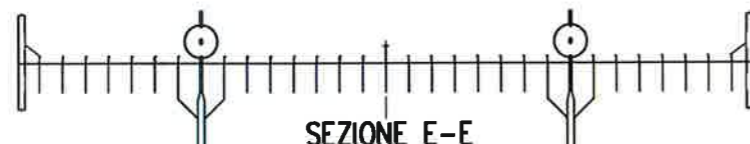
VISTA DALL'ESTERNO FASCIAME POSTERIORE (Ossatura 01, spessore 9 mm)
